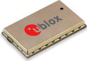
그림 2: 유블릭스의 SARA-G3: 인 밴드 모뎀(in-band modem)으로 eCall이 GSM 모듈을 작동시킴
