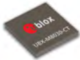
그림 4: 자동차용 추측 항법 기능이 탑재된 eCall과 ERA-GLONASS를 위한 유블릭스 UBX-M8030 GPS/GNSS 수신기 칩
